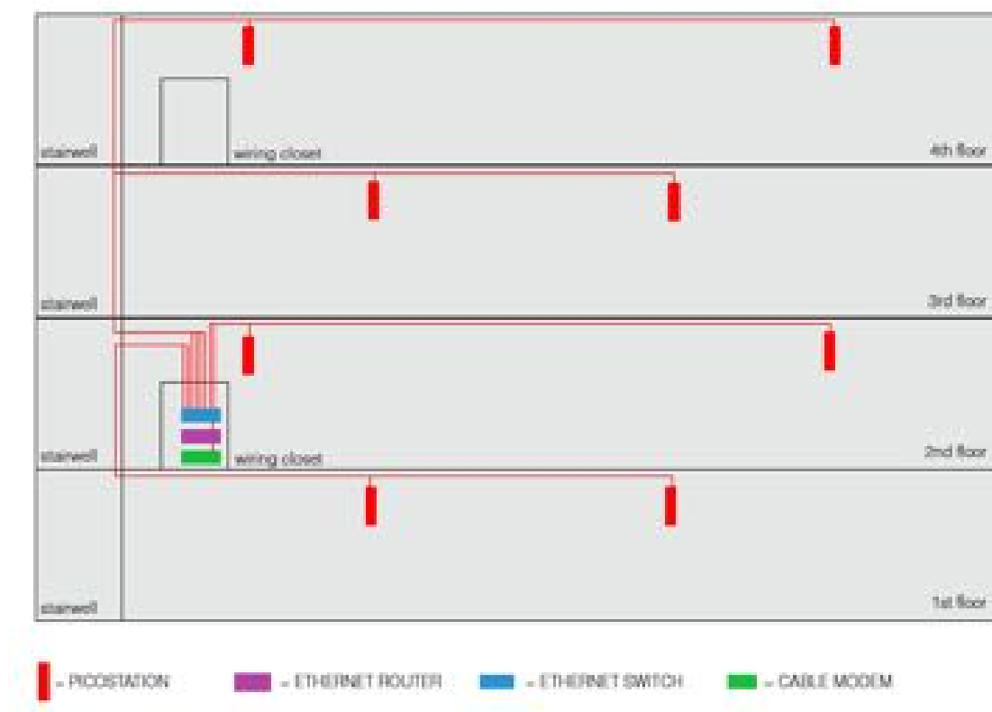
Figure 17 — Emplacement idéal des picostations dans le BAL (3 e version suggérée). Crédits : Peña Gangadharan / Ford Foundation – 2012.
