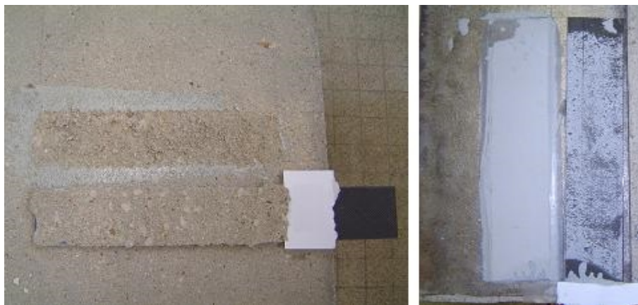
FIGURE 4.2: Photos des modes de rupture obtenus sur adhérent béton et acier Chataigner et al. (2011a)
