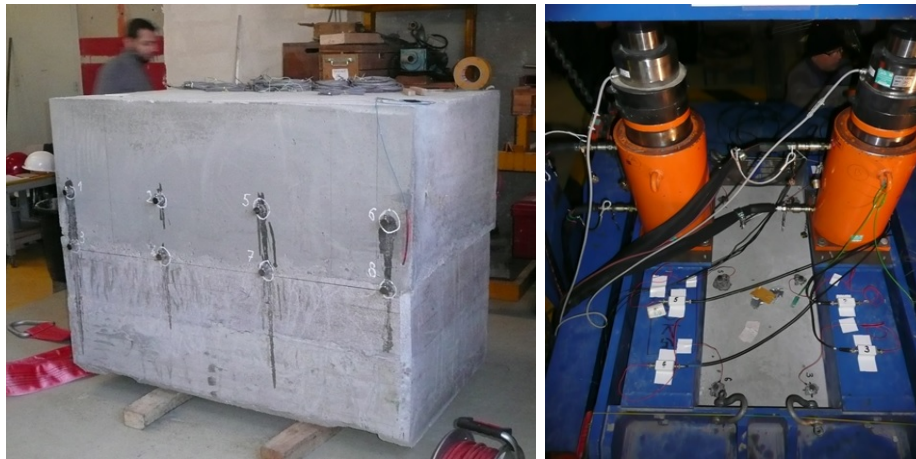
FIGURE 7.6: Photo de l'éprouvette testée avec l'instrumentation mise en place sur un des côtés à gauche, et photo du dessus de l'éprouvette pendant l'essai avec l'instrumentation mise en place en face supérieure à droite
