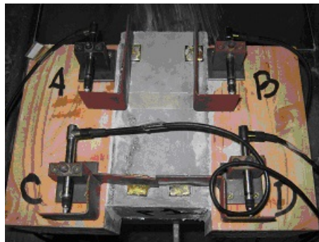
FIGURE 5.3: Photo d'une éprouvette instrumentée pour mesurer 4 glissements locaux à l'interface
