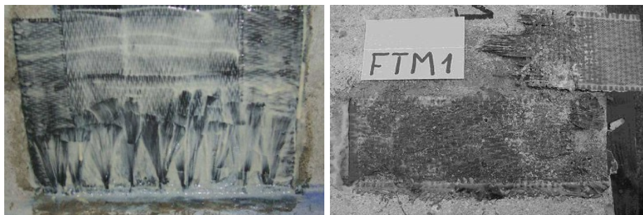
FIGURE 3.7: Photos de la solution des mèches d'ancrage pour tissu et d'un échantillon de cisaillement après essai LCPC (2006)
