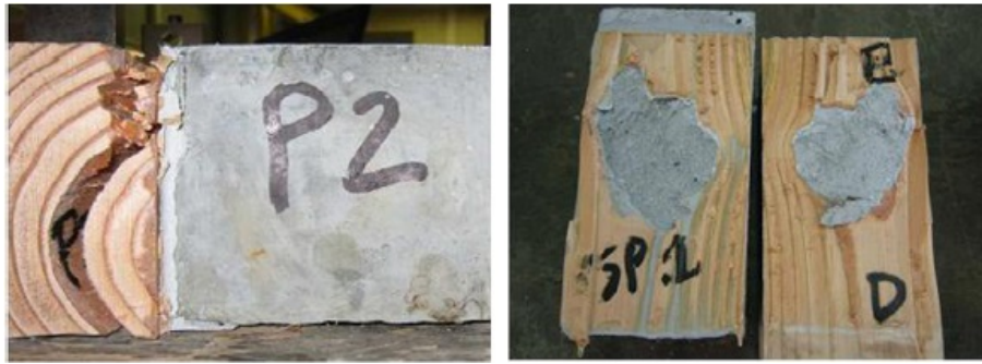
FIGURE 5.4: Photos de modes de rupture observés d'éprouvettes Push-Out avec de la résine époxy : rupture dans le plan des cernes à gauche et influence d'un noeud présent dans l'adhérent bois sur le mode de rupture à droite Chataigner et al. (2011c)
