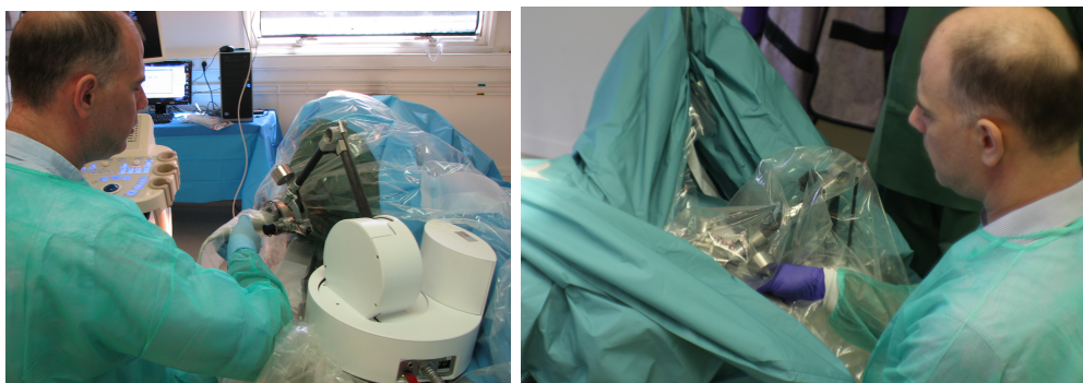
FIGURE 4.6 – Installation du robot Apollo lors des validations sur sujets anatomiques (à gauche en décubitus latéral le robot est posé sur la table derrière les mollets du sujet ; à droite en position gynécologique, le robot est placé sur un tabouret entre les jambes du sujet).
