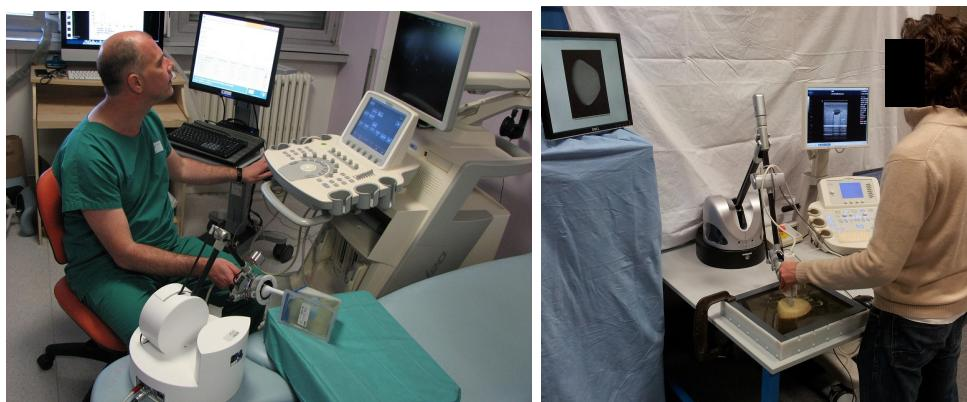
FIGURE 3.1 – Comanipulateurs transparents exploitant des technologies haptiques : à gauche, le robot Apollo, pour les biopsies de prostate et à droite, le robot Virtuose 6D utilisé, ici, pour le diagnostic du cancer du sein
