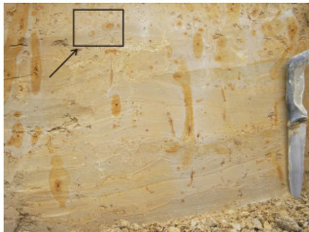
Photo 16 - Lille « Rue Hegel » : coupe 1, détail de l'unité 11b très fins litages de sablon et de quelques lits argileux en petits chenaux interstratifiés ; le faciès passe latéralement à un limon lité (11a)
