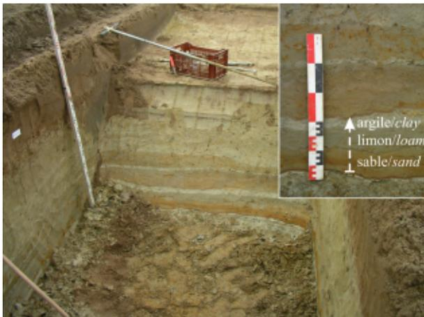
Photo 66 - Scarpe « gazoduc » : unité 5, lits de sable et d'argile
