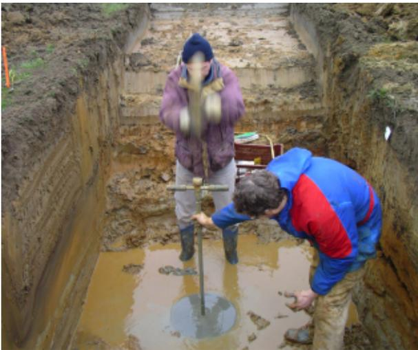
Photo 62 - Scarpe « gazoduc » : test à la tarière manuelle
