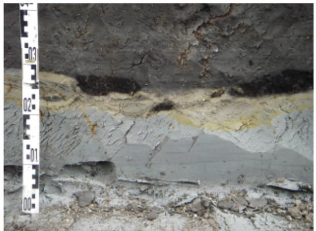
Photo 31 - Billy-Berclau « Le Marécaux » : détail de blocs de tourbe à la base du chenal
