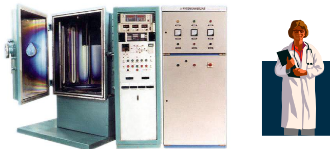
a/ Exemple de réacteur de dépôt industriel pour l'industrie de l'automobile (Sichuan Goldstone Orient New Material Equipment Co., Ltd., Chine).
