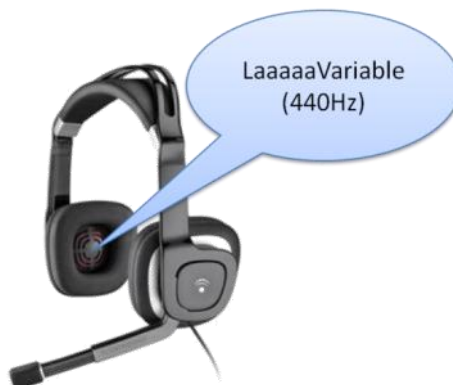
Figure 4-14 : Illustration de la technique BipSolo. Exemple d'utilisation : « J'entends un son pendant une certaine durée, puis plus rien. J'estime la valeur transmise »
