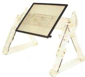
Figure VII-4 : Tablette graphique amagnétique utilisée dans l'appareil d'IRM pour recueillir le tracé d'écriture.
