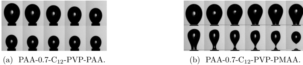
Figure 6: Profil des gouttes lors de la compression de l'interface dans le cas de tricouches (lecture de gauche à droite puis de haut en bas). L'analyse du profil permet de mettre en avant le caractère viscoélastique de l'interface dans le cas du PAA-0.7-C 12 -PVP-PMAA qui combine un fort ancrage des polymères à l'interface, des liaisons hydrogènes et des interactions hydrophobes.
