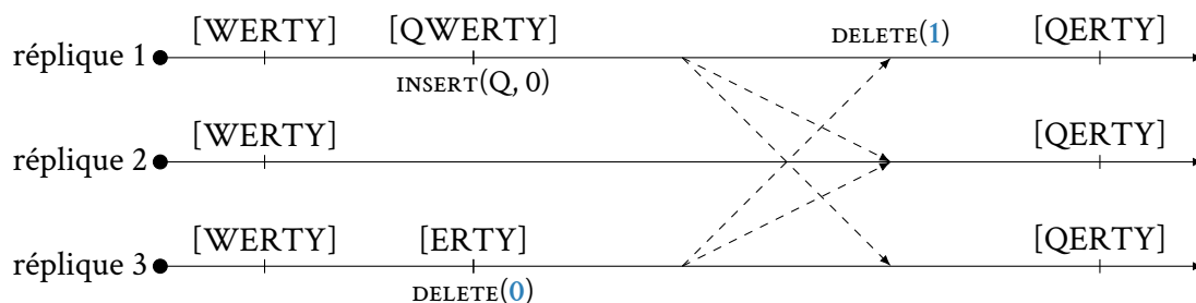
FIGURE 2.3 – Exemple de scénario impliquant des transformées opérationnelles. L’opération de suppression du premier caractère sur la réplique 3 est transformée afin de supprimer le second caractère sur les autres répliques.
