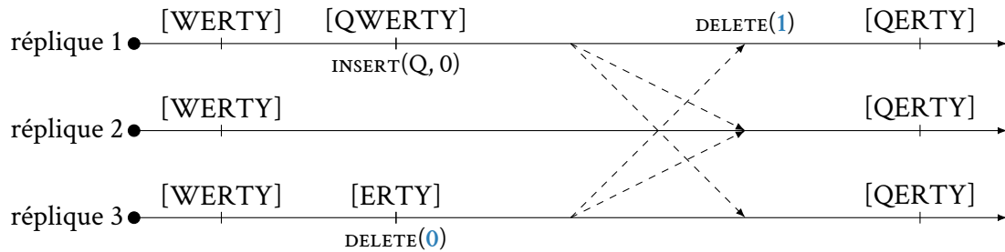
FIGURE 2.3 – Exemple de scénario impliquant des transformées opérationnelles. L’opération de suppression du premier caractère sur la réplique 3 est transformée afin de supprimer le second caractère sur les autres répliques.
