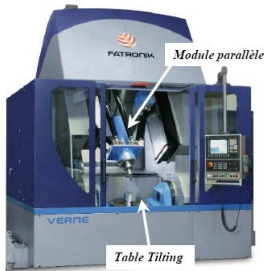
Figure 1.11 : La machine Verne construite par Fatronik pour l'IRCCyN
