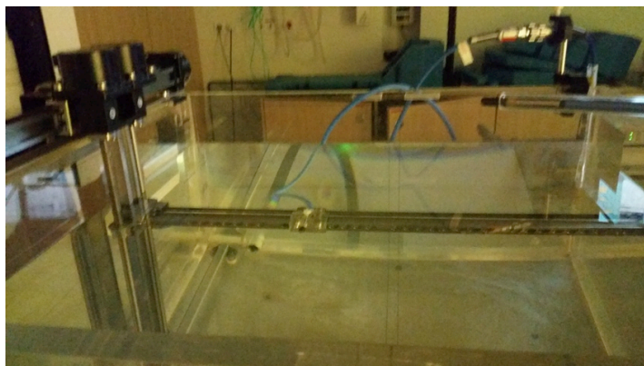
Figure III-13 : Visualisation de la chambre d'ionisation fixée sur son support dans la cuve d'eau (zoom sur la chambre).
