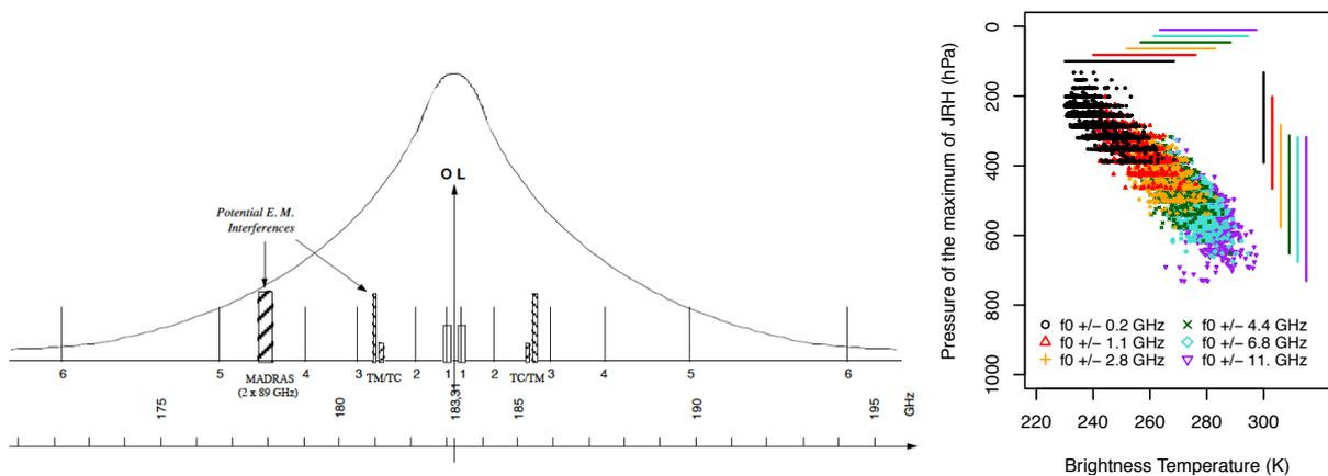
**FIGURE 10 :** (gauche) Position des 6 canaux de SAPHIR dans la raie 183,31GHz. Figure tirée de Eymard et al. (2002). (droite) Distributions des positions des maxima des jacobiens  $\mathcal{K}_{RH}$  en fonction de la TB pour chacun des 6 canaux de SAPHIR (1 canal=1 couleur) obtenus à partir de d'une base de profils synthétiques. Les traits horizontaux et verticaux représentent la gamme des valeurs couverte dans chaque configuration. Figure tirée de Brogniez et al. (2016).
