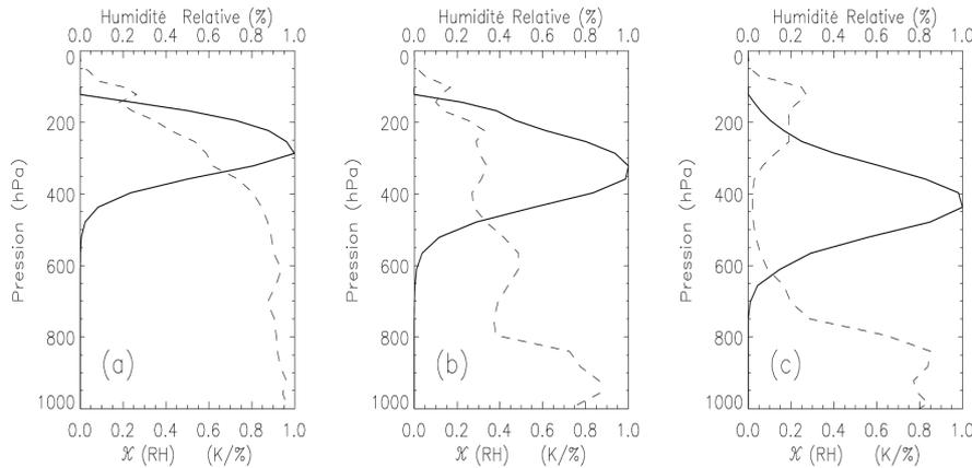
**FIGURE 6:** Jacobiens  $\mathcal{K}_{RH}$  (courbes pleines) du canal  $6,3\mu\text{m}$  METEOSAT pour 3 atmosphères tropicales : (a) humide, (b) standard et (c) sèche. Les profils de RH associés sont les courbes tiretées. Figure tirée de Brogniez (2004).
