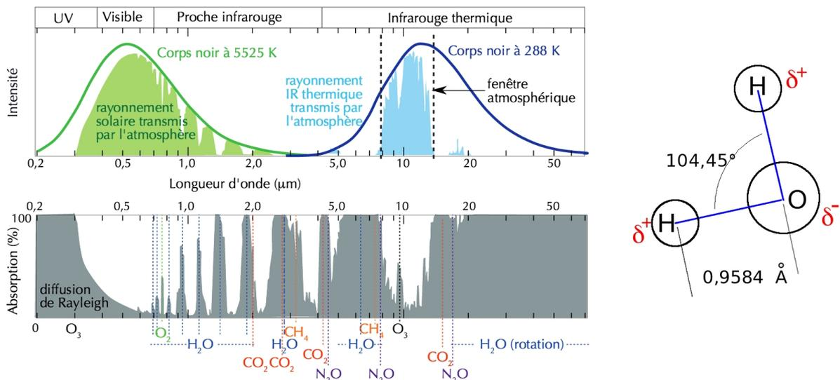
**FIGURE 2: (gauche)** Spectres d'émission (haut) et d'absorption (bas) par l'atmosphère du rayonnement solaire et du rayonnement terrestre émis par le sol, en l'absence de nuages et d'aérosols (Figure tirée de Poitou, 2013). **(droite)** Schéma de la molécule d'eau et de son dipôle.
