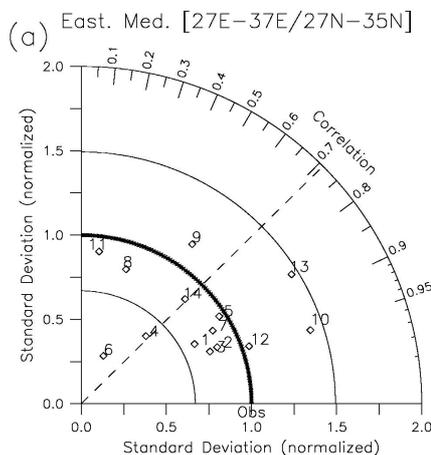
**FIGURE 18 :** Diagramme de Taylor décrivant le cycle saisonnier moyen de la FTH dans l'Est de la Méditerranée pour chacun des 14 modèles (repérés par un numéro). Dans ce type de diagramme polaire, l'angle et le rayon représentent respectivement le coefficient de corrélation aux observations et l'écart-type normalisé. Les modèles les plus performants sur ce test sont ceux qui se rapprochent le plus de la référence « obs ». Figure tirée de Brogniez et al. (2005).
