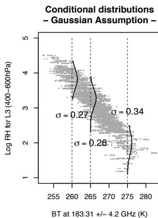
**FIGURE 11 :** Distribution de la moyenne de RH de la couche 400-600hPa (échelle log) selon la TB du canal 4 de SAPHIR. Les distributions conditionnelles de RH pour 3 TBs (260K, 265K et 275K) sont dessinées et les écarts-types correspondants sont indiqués. Figure tirée de Brogniez et al. (2016).
