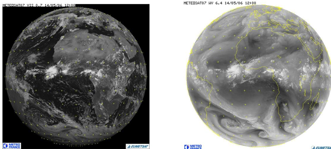
**FIGURE 1 :** (gauche) Observation réalisée avec le canal « visible » à  $0,7\mu\text{m}$  et (droite) avec le canal « Vapeur d'eau » à  $6,3\mu\text{m}$  de l'instrument MVIRI (« METEOSAT Visible and Infra-Red Imager ») du satellite METEOSAT-7. Observations du 14 mai 2006 à 12 :00TU.
