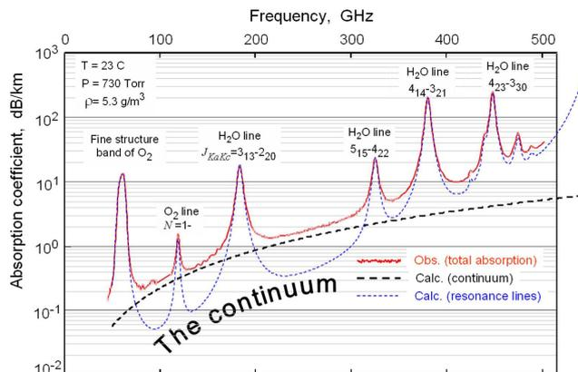
**FIGURE 9:** Spectre d'absorption atmosphérique obtenu en laboratoire. Les raies de résonance (courbe tiretée bleue), le continuum (courbe tiretée noire) et l'absorption totale (courbe rouge) sont indiqués. Courtoisie Microwave Spectroscopy Laboratory.
