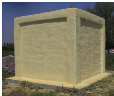
(b) Cabine avec isolation en polyuréthane
