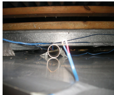
(b) Mesure de la température d'air de la zone supérieure.
