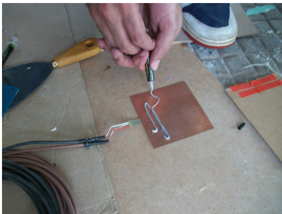
(a) Application d'une pâte thermo-conductrice.
