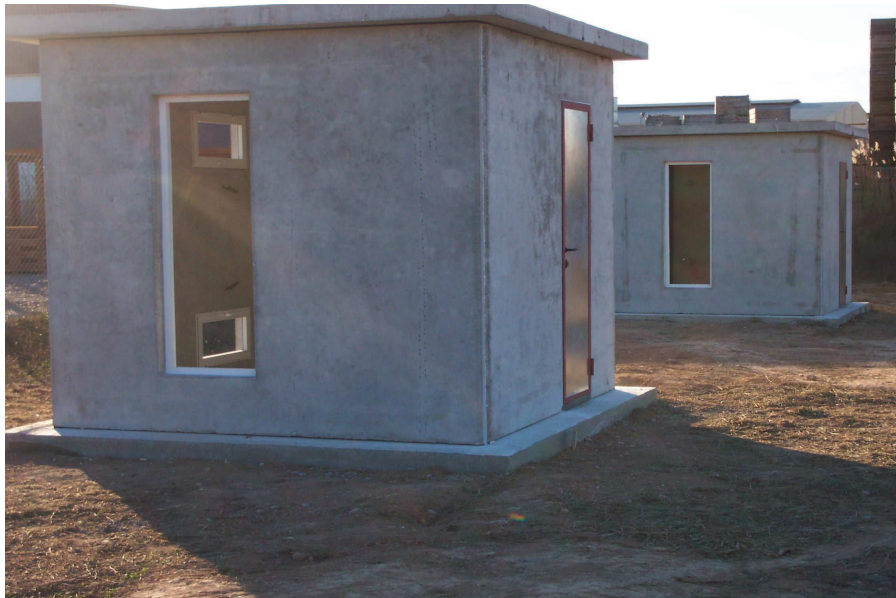
Figure I.4 : Photo de la cabine de dimensions 2.4 m × 2.4 m × 2.4 m [Cabeza et al. , 2007]
