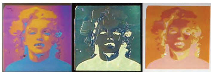
Fig. 24. Image inscrite par laser sur verre enduit d'oxyde de titane ( 2 \times 2 cm), éclairée par l'avant (à gauche), de côté (au centre) et par l'arrière (à droite).
