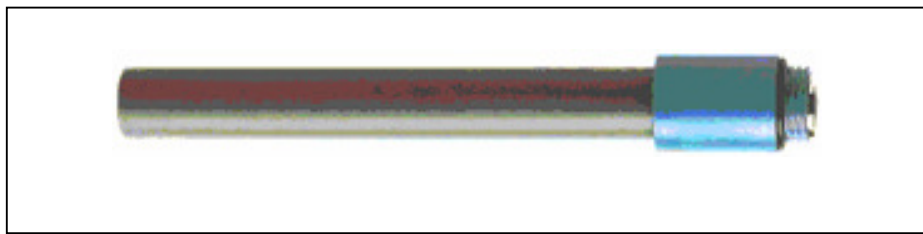
Figure 2 : Photographie d'une électrode sélective à membrane PVC commercialement disponible (Radiometer). La membrane se fixe à l'extrémité gauche.
