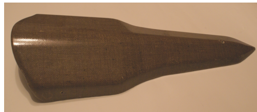
FIGURE 9.18 – Nez de kart en fibres végétales comportant neuf transducteurs piézocéramiques
