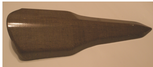
FIGURE 9.18 – Nez de kart en fibres végétales comportant neuf transducteurs piézocéramiques
