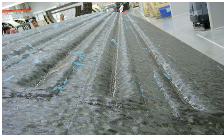
FIG. 5.32 – La surface rugueuse de la pièce composite élaborée à base de plis pré-imprégnés Hextool.
