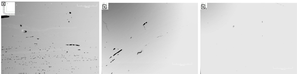
(a) (b) (c) FIG. 3.7 – Images en électrons rétrodiffusés de HexTOOL avec un grandissement de 25x
