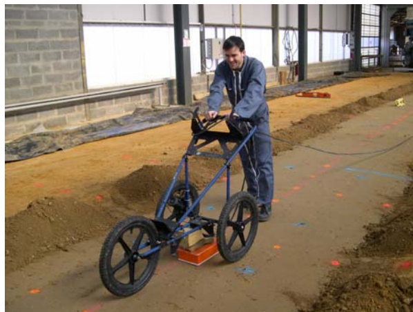
Figure 7.14 : Réalisation d'un profil radar sur une planche d'essai avec une antenne de 900 MHz.
