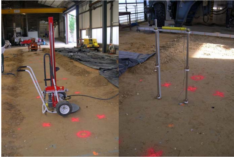
Figure 7.11 : Mise en place (à gauche) et mesure (à droite) par double sonde gamma
