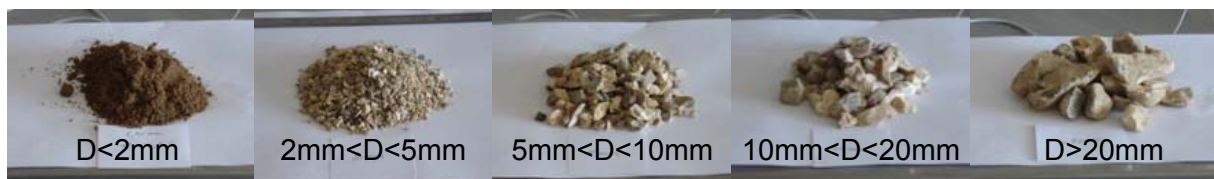
Figure 7.67 : Séparation des cinq fractions granulométriques du sol limoneux de diamètre D.
