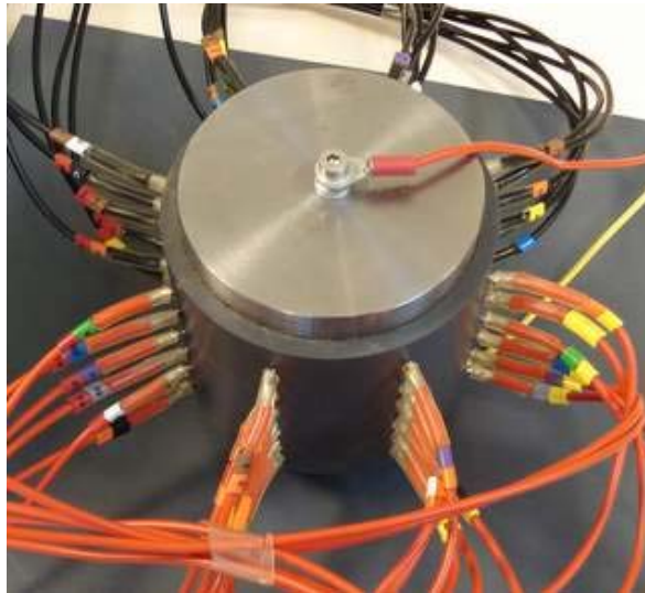
Figure 5.17 : Cellule de mesure de résistivité par transparence à 48 électrodes adaptée à la géométrie des échantillons utilisés pour la mesure de permittivité.
