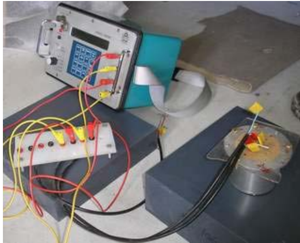
Figure 5.14 : Dispositif expérimental de mesure de résistivité du sol placé à la surface du porte-échantillon métallique de la sonde électromagnétique.
