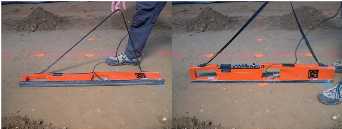
Figure 7.18 : Conductivimètre EM38 (Geonics) en position horizontale (a), avec les boucles perpendiculaires à la surface du sol (dipôles magnétiques horizontaux : mode HD), et en position verticale (b), avec les boucles parallèles à la surface du sol (dipôles magnétiques verticaux : mode VD).
