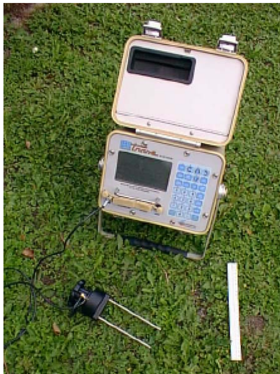
Figure 3.12 : Exemple de dispositif TDR de surface : appareil TRASE 6050X1 (Soilmoisture Equipment Corp.) reliée à sa sonde « Connector » (à gauche).
