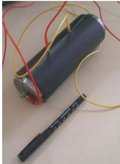
Figure 5.16 : Cellule de mesure de résistivité par transparence avec deux électrodes surfaciques d'injection du courant et deux électrodes de potentiel implantées dans le matériau.
