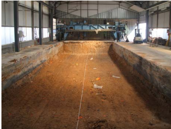
Figure 7.2 : Vue de la fosse d'essai décamétrique vide reposant sur le terrain naturel.
