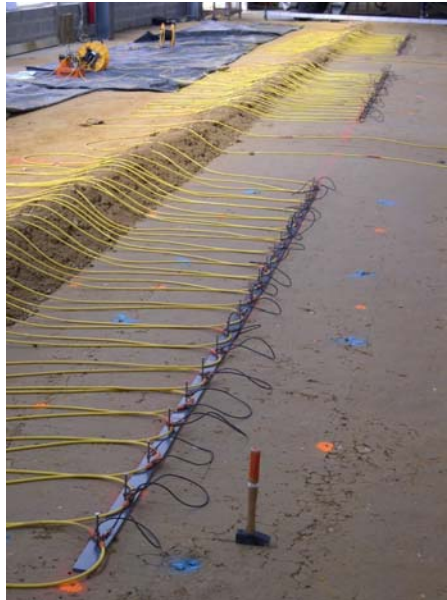
Figure 7.17 : Dispositif de mesure par TRE sur les trois plots d'une planche de limon compacté (3 profils de 20 électrodes).
