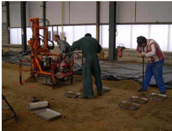
Figure 7.9 : Prélèvement de limon (par foreuse, à gauche, et par tarière à main, à droite) pour les mesures de teneur en eau
