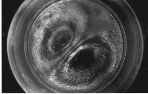
FIGURE 1.11 – Une paire de tourbillons contra-rotatifs dans un film de savon en vibration, tiré de [1].
