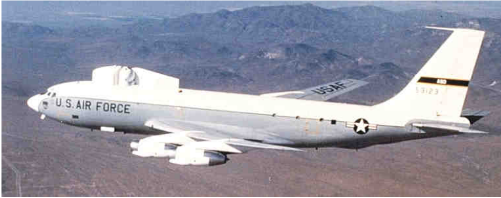
Figure 3 : L'Airborne Laser Lab (ALL) embarqué sur NKC-135A, l'ancêtre de l'ABL utilisant un laser CO 2 de la classe 500 kW.
