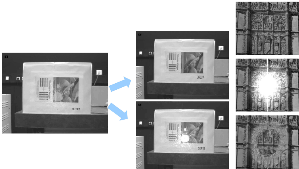
Figure 35 : A gauche, extraction de la trame non éblouie d'une image de caméra CCD bas coût éblouie par laser à basse cadence (10 Hz). A droite, restauration d'une image éblouie dans une séquence vidéo par diffusion 3D (extrait de [48]). Dans les deux cas, on observe qu'une séquence vidéo dont toutes les trames et images ne sont pas éblouies reste exploitable, moyennant un traitement d'image approprié.
