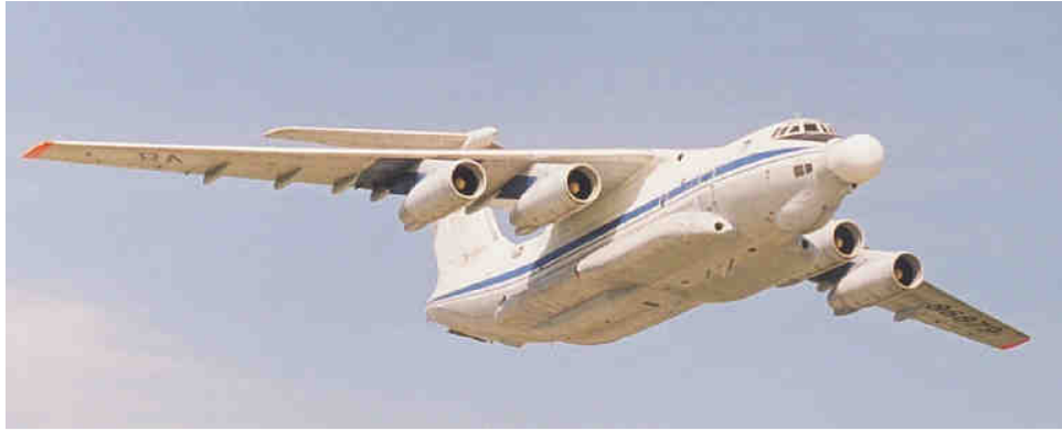
Figure 6 : Démonstrateur russe A60 d'arme laser aéroportée, embarqué sur avion de transport militaire Iliouchine Il-76MD.
