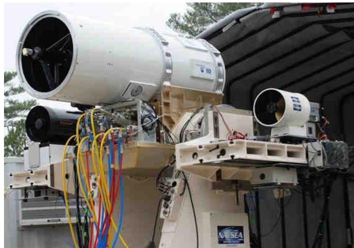
Figure 10 : Photo de la tourelle et de la tête optique du système LaWS américain, utilisé en 2009-2010 pour une campagne de destruction de drones.
