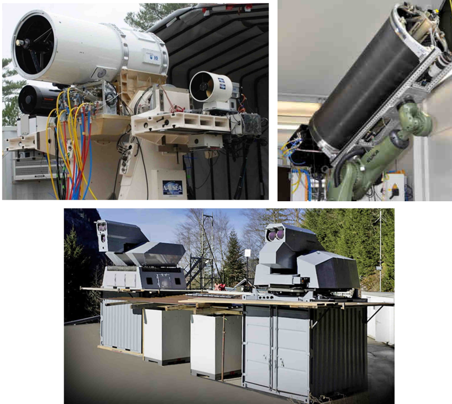
Figure 69 : Prototypes de systèmes d'armes laser de l'US Navy (LaWS en haut à gauche), de MBDA (en haut à droite) et de Rheinmetall (en bas). Tous ces prototypes utilisent la technique de superposition de faisceaux laser sur cible pour combiner plusieurs faisceaux de lasers à fibres IPG Photonics 5 - 10 kW.
