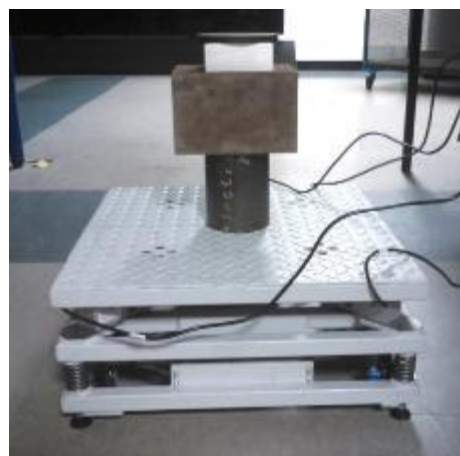
Figures 65. (a) Modèle de la plate-forme de force et (b) plate-forme de force développée au laboratoire G-SCOP
