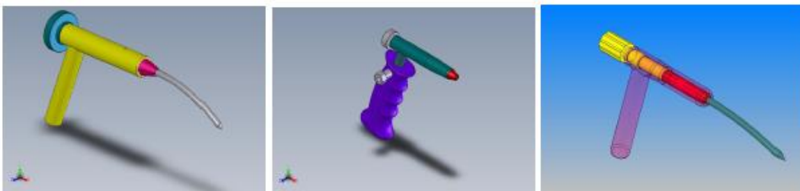
Figures 22. Images CAO de trois propositions d'instrument chirurgical pour l'arthrodèse lombaire
