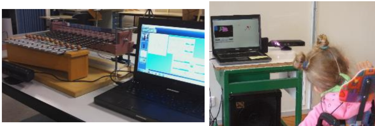
Figures 57. (a) Kinect installée avec le système mailloches de métallophone, (b) enfant en fauteuil utilisant la Kinect avec sa tête
