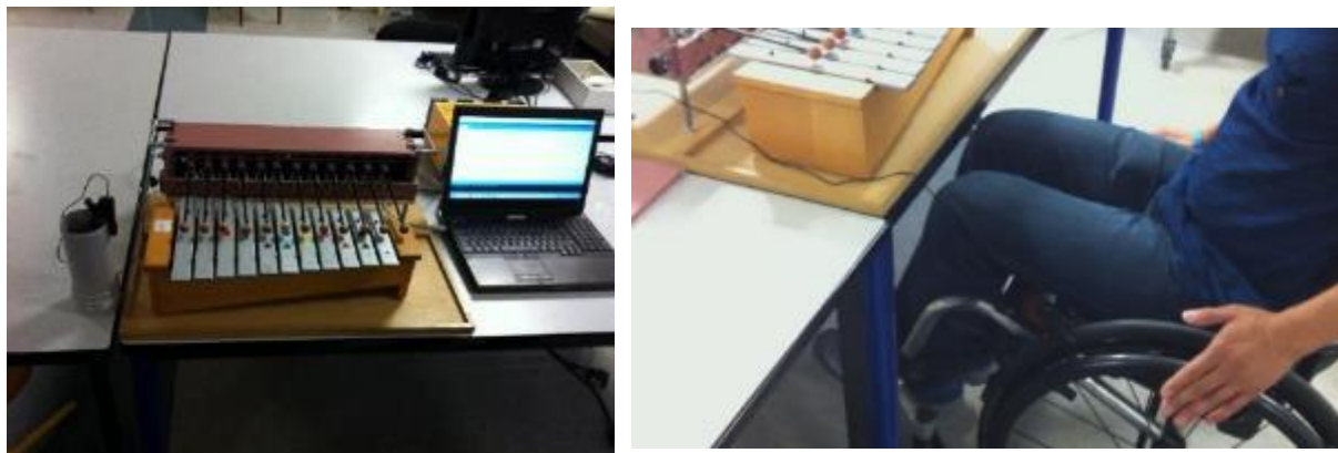
Figures 56. (a) PPM reliée aux mailloches d'un métallophone (b) PPM fixée sur la roue d'un fauteuil manuel
