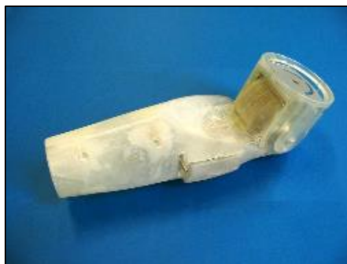
Figures 10. Corps et coude de la prothèse – CAO et prototypage rapide
