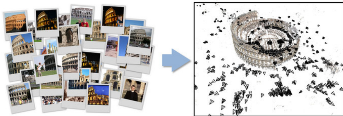
FIGURE 2 – Exemple de reconstruction 3D de l'article Building rome in a day , à gauche un ensemble de photos de touristes, à droite le résultat de l'algorithme de reconstruction 3D, la position des caméras (tétraèdre dans l'image) et le modèle 3D de la scène sont retrouvés.
