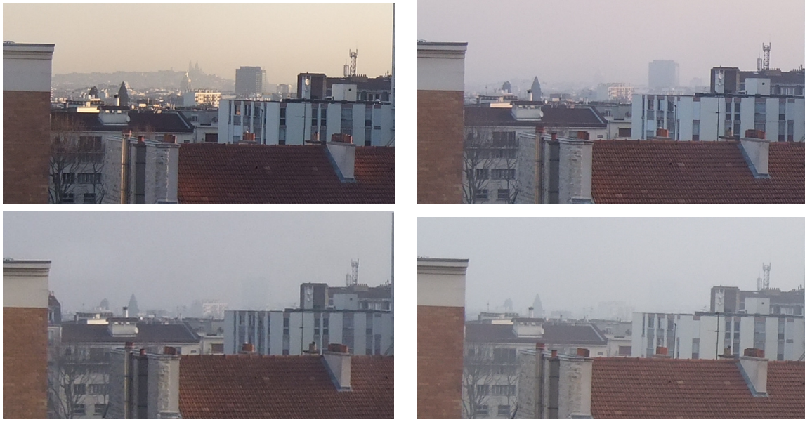
FIGURE 2.2 – Atténuation de contraste de la même scène en fonction de différentes valeurs du coefficient d’extinction \beta .
