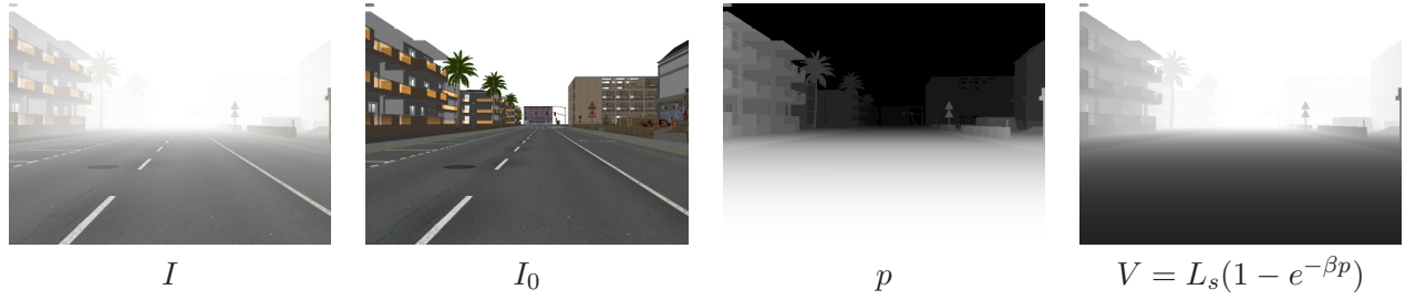
FIGURE 2.3 – Variables liées par l'équation de Koschmieder sur une image de synthèse. De gauche à droite, l'image I correspondant à la luminance de la scène observée en présence de brouillard, l'image I_0 correspondant à la luminance sans brouillard, la carte de profondeur p de la scène (avec une transformation gamma), le voile atmosphérique V pour un \beta et un L_s donné.
