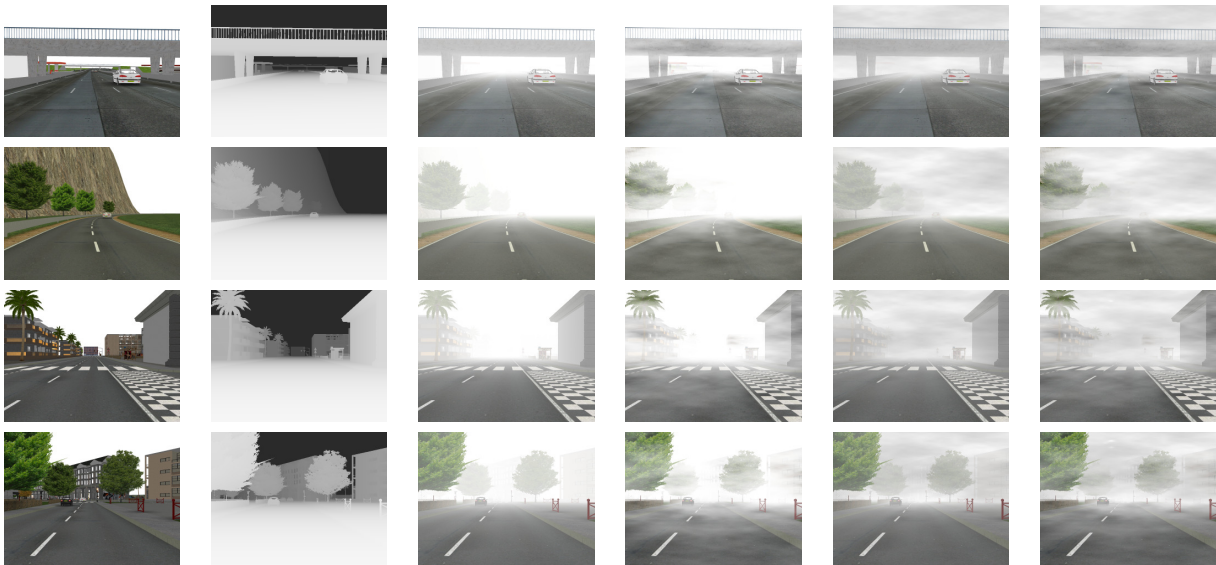
FIGURE 2.8 – Base de données d’images de synthèse en environnement routier. La première colonne représente l’image de synthèse sans brouillard. La deuxième colonne représente la carte de profondeur associée à la scène. À partir de la troisième colonne, l’image originale avec l’ajout de différents types de brouillard artificiels. De gauche à droite : avec un brouillard homogène, avec un brouillard hétérogène où \beta varie, avec un brouillard hétérogène où L_s varie, avec un brouillard hétérogène où \beta et L_s varient.
