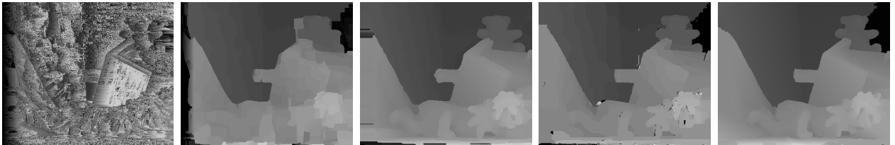
FIGURE 1.5 – Exemple de résultats avec la prise en compte de l'hypothèse spatiale. De gauche à droite : l'hypothèse photométrique seule, avec l'hypothèse spatiale locale [SS02] plus filtrage médian, semi-globale [Hir05], globale avec une régularisation du premier ordre [KZ01] et du second ordre [WTRF09].
