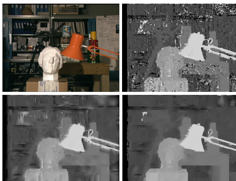
FIGURE B.11 – Première ligne : à gauche, l'image originale de la paire stéréo et la carte de disparité obtenue en utilisant un algorithme de reconstruction dense. Seconde ligne : la carte de disparité affinée par le filtre bilatéral croisé et le filtre bilatéral guidé
