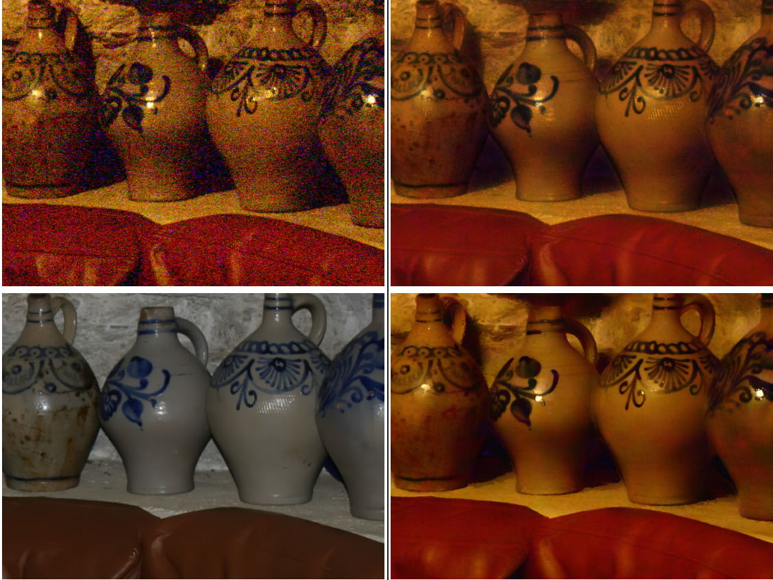
FIGURE B.3 – Première colonne : l'image originale avec et sans flash. Seconde colonne : en haut, le résultat obtenu dans [PSA + 04]. En bas, en utilisant le filtre bilatéral robuste sur l'image sans flash et avec comme guide l'image avec flash
