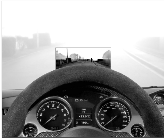
FIGURE 5 – Exemple de système d’amélioration de la vision en présence de brouillard. Une caméra avec l’image de la route captée et restaurée est placée sur le tableau de bord.
