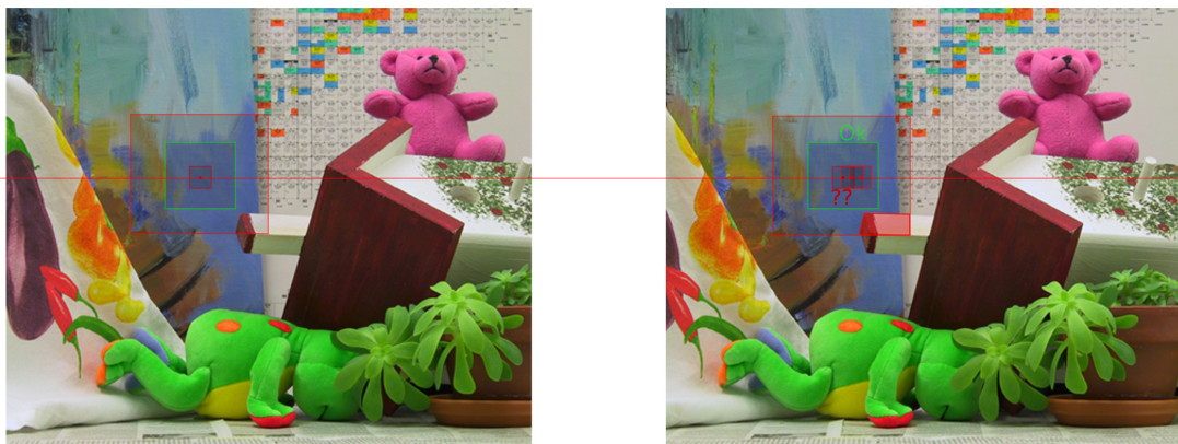
FIGURE 1.6 – Principe des algorithmes fondés sur l'appariement local par fenêtre multi-échelles. Trois gabarits de tailles de voisinage sont utilisés comme descripteur. La plus petite est sujette à une forte ambiguïté étant donné qu'elle ne couvre qu'une zone homogène. La grande fenêtre recouvre un autre objet : l'appariement ne sera donc pas optimal. Une taille de fenêtre intermédiaire est le meilleur choix. Une zone assez conséquente est couverte qui permet de lever les ambiguïtés, et la totalité de cette zone correspond à une même disparité
