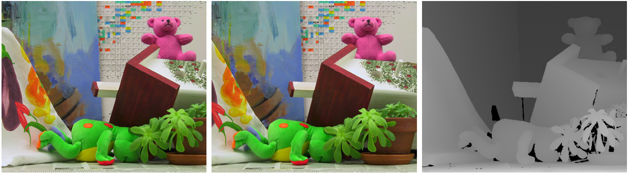
FIGURE 1.4 – L'image gauche et droite d'une paire stéréoscopique et la vraie carte de disparité de la scène.
