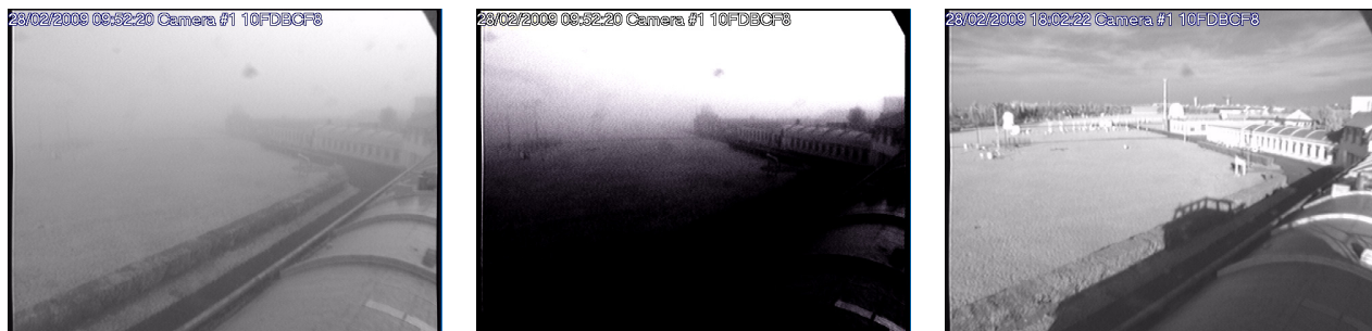
FIGURE 2.1 – Une image en présence de brouillard (image de gauche). La même image avec une transformation gamma permet de faire ressortir les objets au loin. La même scène avec un temps dégagé.
