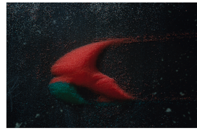
Illustr. VII.4. – Collision aquatique de deux dunes constituées de sable de couleurs différentes, auteur H. Raguey [181].
