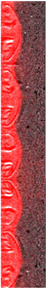
Illustr. X.2. – Vue de l'entrefer d'un dispositif de Taylor-Couette, le cylindre intérieur tournant est à gauche. On observe les rouleaux de Taylor dans la bande illuminée par une nappe laser. La seconde bande est diffusante [127].
