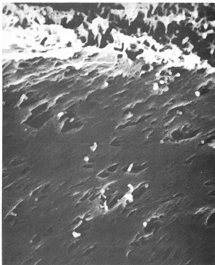
Figure 15 : FILMS DE POLYACETYLENE LAMINES: DISSIMULATION DE LA STRUCTURE FIBRILLAIRE . CLICHES DE M.E.B.
