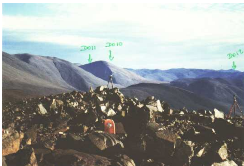
FIGURE 2.18: Photographie du site principal DO10 et des deux sites auxiliaires lors d'une mesure commune permettant d'établir précisément la distance de rattachement entre les marqueurs.
