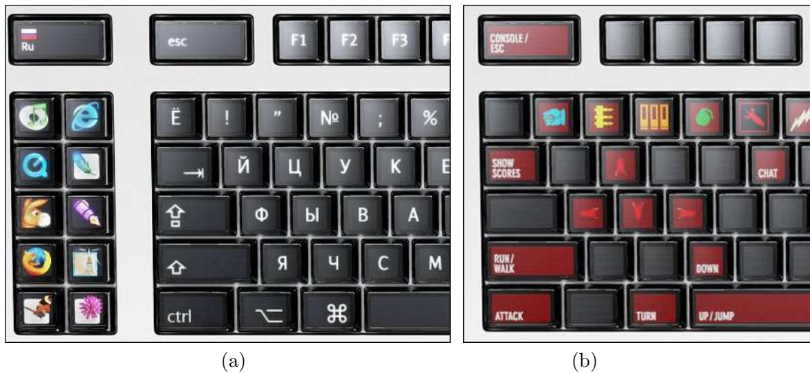
Figure 37 : Photos du clavier Optimus Maximus . (a) La clavier avec l'ordre des touches Russe. (b) Le clavier configuré pour le jeu vidéo de tir subjectif Quake de l'éditeur id Software .
