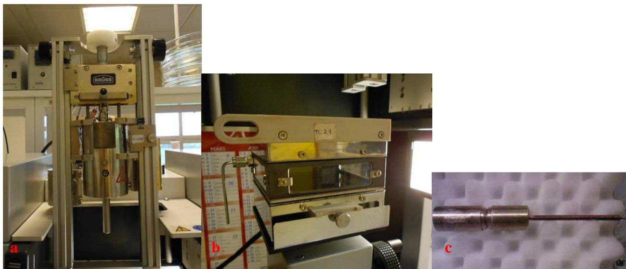
Figure III.11 – (a) cellule de dosage des bitumes, (b) chambre en température des bitumes, (c) aiguille en laiton.
