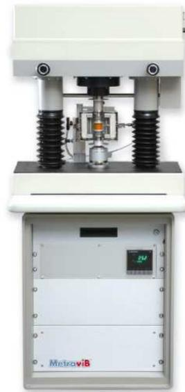
Figure A.4 – Analyseur dynamique mécanique.
