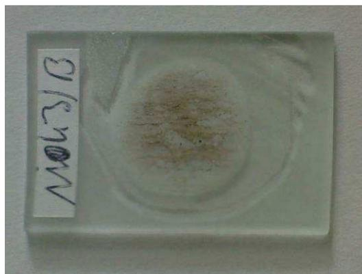
Figure III.5 – Lame mince de gneiss de 30  $\mu\text{m}$  d'épaisseur.
