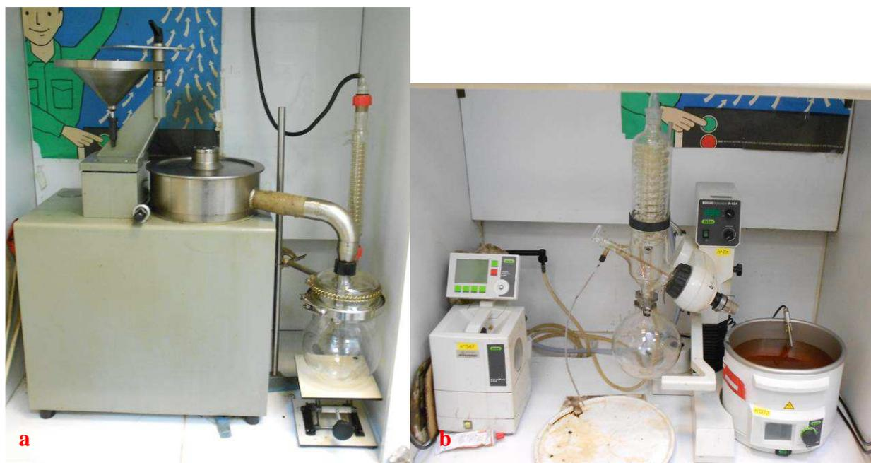
Figure A.1 – Centrifugeuse (a) et évaporateur rotatif pour la distillation des liants (b).
