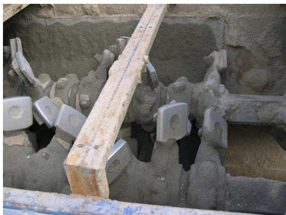
Figure II.17 – Malaxeur de la centrale d'enrobage à froid.
