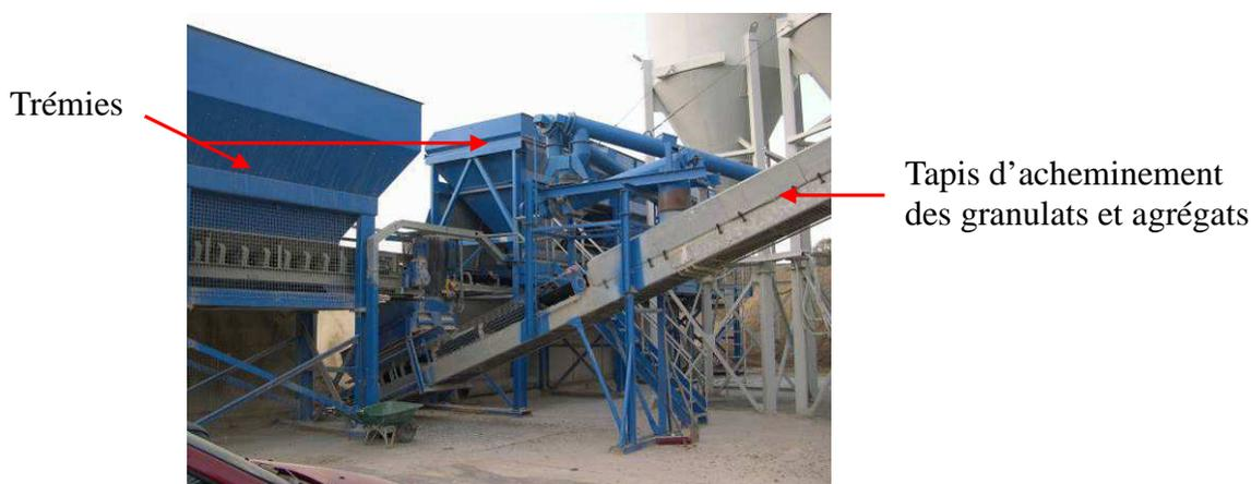
Figure II.18 – Dispositif de stockage et d'acheminement des granulats et agrégats.
