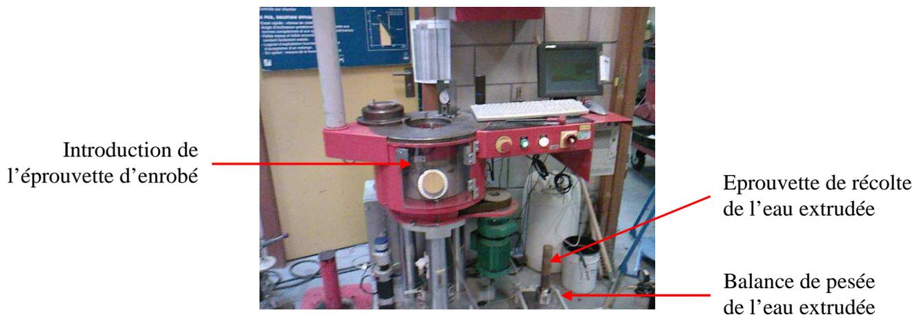
Figure II.20 – Presse à Cisaillement Giratoire (PCG).
