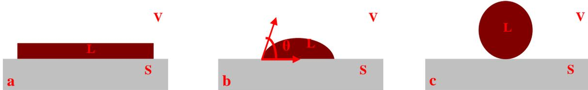
Figure I.25 – Les différents régimes de mouillage. (a) mouillage total, (b) mouillage partiel, (c) mouillage nul. Légende : L – liquide, S – solide, V – vapeur (gaz).
