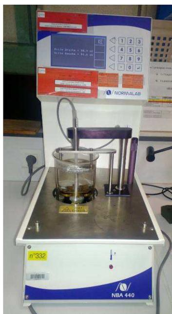
Figure A.3 – Appareil de mesure de la TBA.
