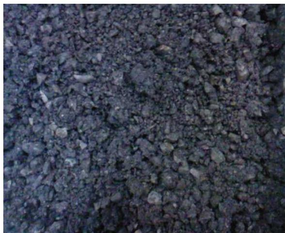
Figure II.24 – Formule F1 réalisée sur le malaxeur BBMAX 25 en sortie de malaxage. Paramètres : émulsion Em5, 5,2 % de liant résiduel, 5,7 % d'eau totale.
