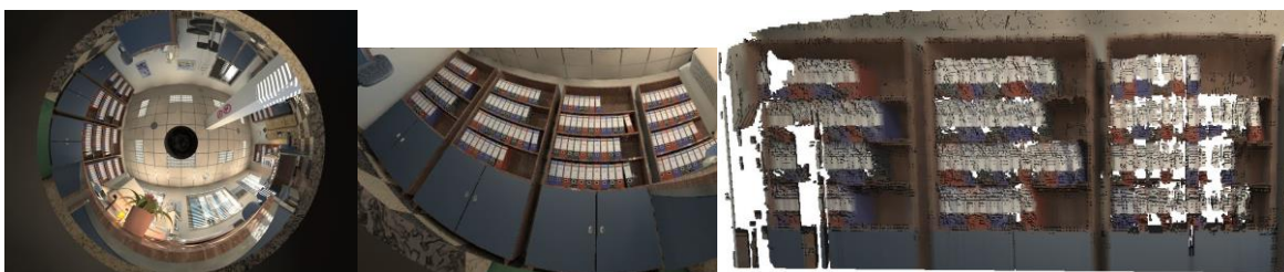
Figure 32 : exemple de résultats obtenus par reconstruction 3D voxélique par vision omnidirectionnelle : image panoramique de la scène (figure de gauche) – zoom sur une partie de la scène (figure centrale) – reconstruction 3D de l'objet (figure de droite)
