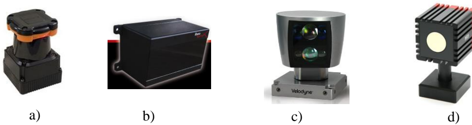
Figure 2 : exemple de capteurs de perception 3D par mesure active : a) UTM-30LX Hokuyo © ; b) Lidar 8 nappes IBEO © ; c) Lidar 64 nappes 360° Velodyne © ; d) caméra ToF Mesa Imaging ©
