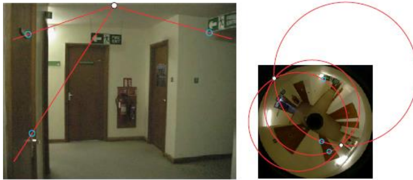
Figure 28 : courbes épipolaires pour une caméra perspective (vue de gauche) et un capteur catadioptrique (vue de droite) (source : [61])
