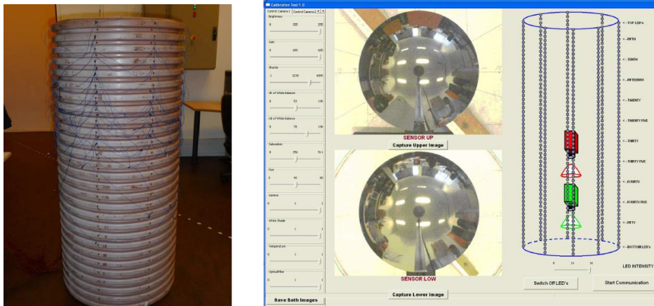
Figure 25 : mire cylindrique pour la calibration 3D/2D et logiciel de contrôle réalisés dans le cadre de la thèse de Nicolas Ragot [Th1]
