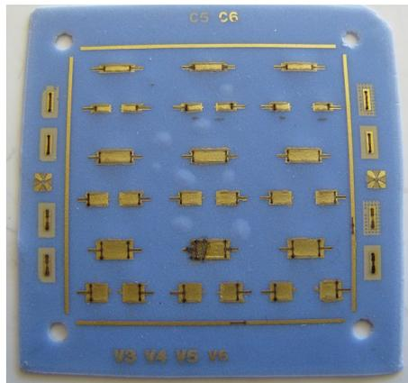
**Figure 120.** Les dispositifs pour tester la transition entre [GLWG](#) et montage [FC](#), en bande  $G$  sur la deuxième ligne du haut,  $W$  sur la quatrième ligne du haut et  $V$  sur la ligne toute en bas. Dans ces cas, les [GLWGs](#) sont tous réalisés sur une seule couche de [LTCC](#).
