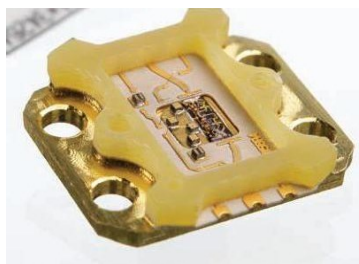
Figure 16. Puce MMIC soudée sur un support [15].
