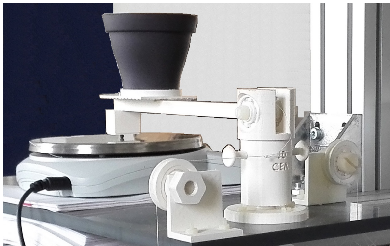
FIGURE E.6 – Dispositif de chargement validé en sollicitations normales avec une balance de précision
