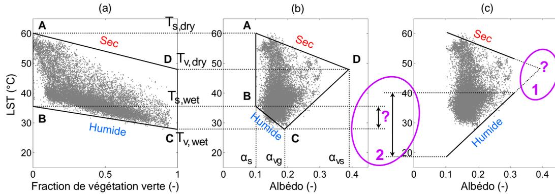
FIGURE 3.2 – Interprétation physique des polygones LST- $f_{gv}$  (a) et LST-albédo (b,c) selon le modèle WDI de Moran *et al.* (1994) en (a), le modèle SEB-1S de Merlin (2013) en (b) et le modèle S-SEBI de Roerink *et al.* (2000) en (c). L’interprétation S-SEBI prévoit un croisement des lignes associées aux bords sec et humide (point 1) et n’est pas compatible (point 2) avec l’interprétation des bords sec et humide de Moran *et al.* (1994).
