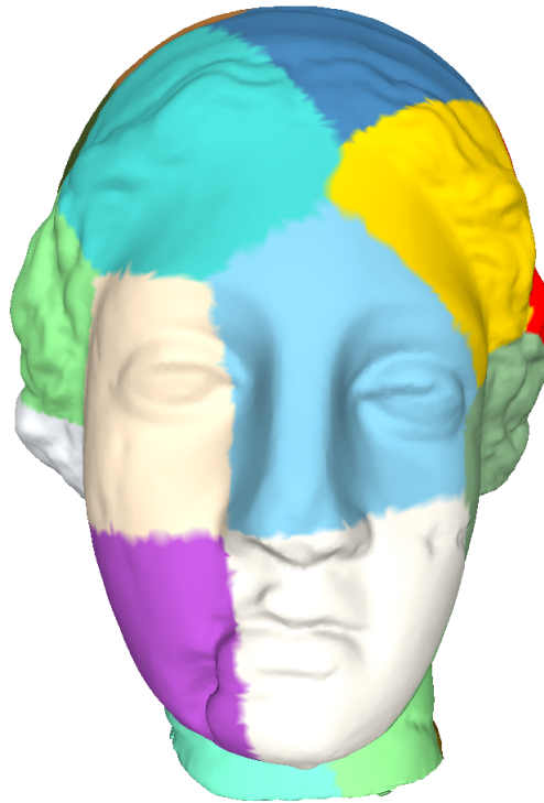
FIGURE 2.8 – Exemple de diagramme de Voronoï, qui est construit sur VENUS.
