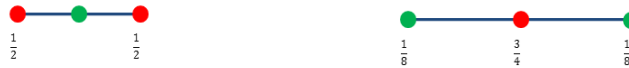
(c) Masque pour un nouveau sommet qui est sur un bord. (d) Masque pour un ancien sommet qui est sur un bord.
