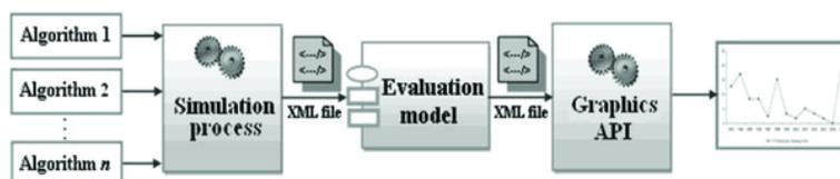
FIG. 5.1 – Le schéma du modèle d'évaluation pour les algorithmes du handover [35]
