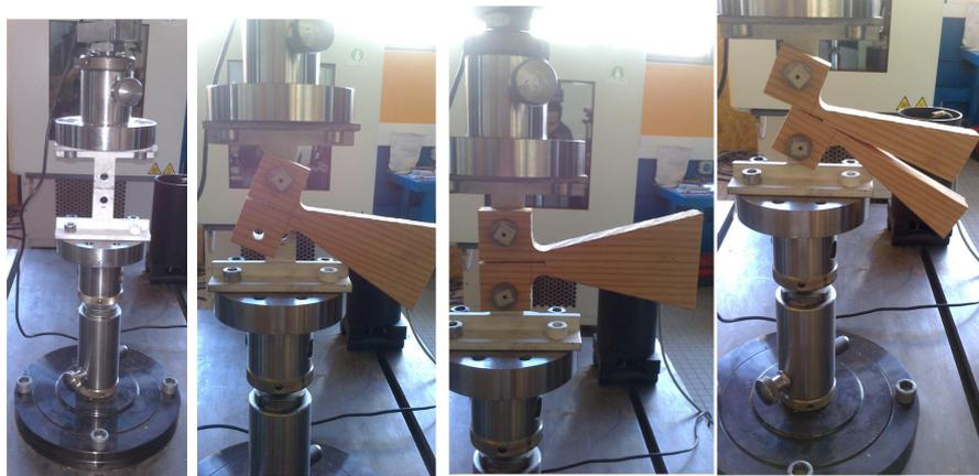
Figure IV.4.1. Dispositif expérimental et étapes d'essai de fissuration en traction
