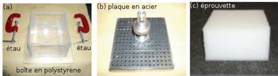
Figure 2.1 – L'équipement utilisé pour les essais en compression confinée
