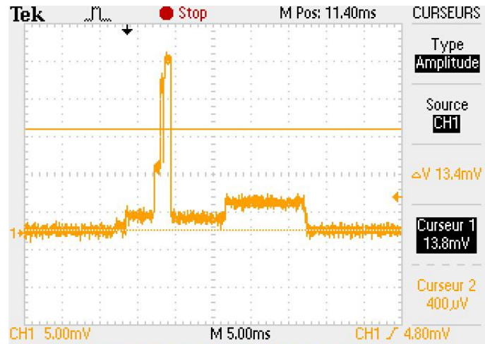
FIGURE 4.11: Profil de consommation pendant une exécution de l'application end-device.
