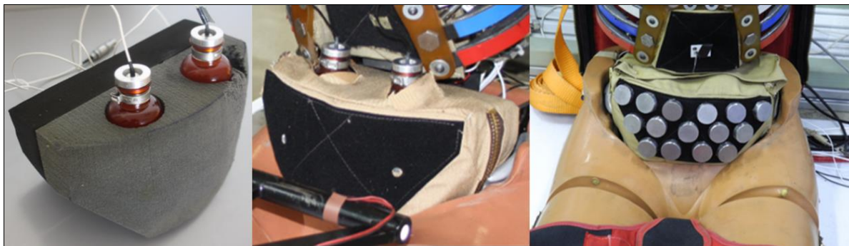
Figure 25 : Prototype d'abdomen avec capteurs de pression APTS® et masses additionnelles
