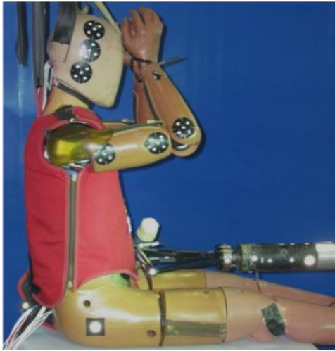
Figure 27 : Essai impacteur avec mannequin THOR NT Source : Hanen et al., 2011
