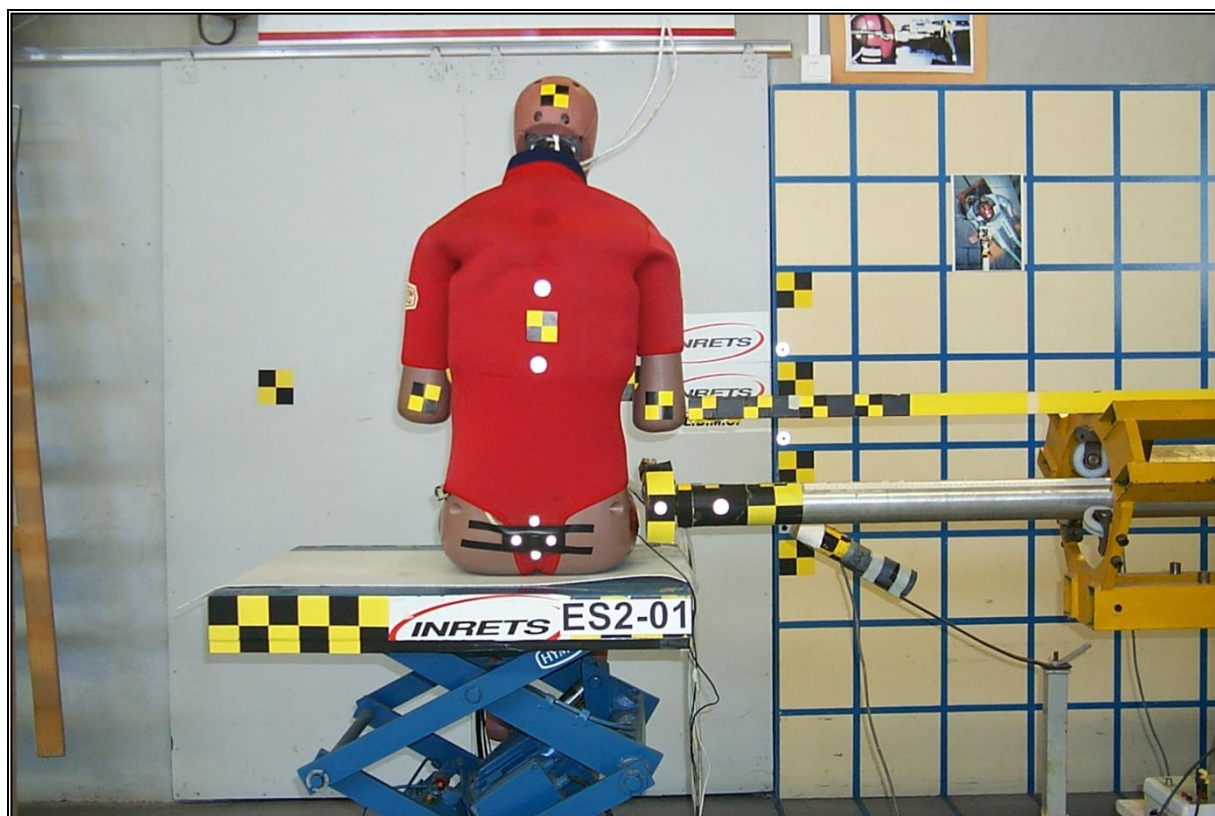
Figure 14 : Essai impacteur au niveau du bassin avec mannequin de choc latéral EuroSID
