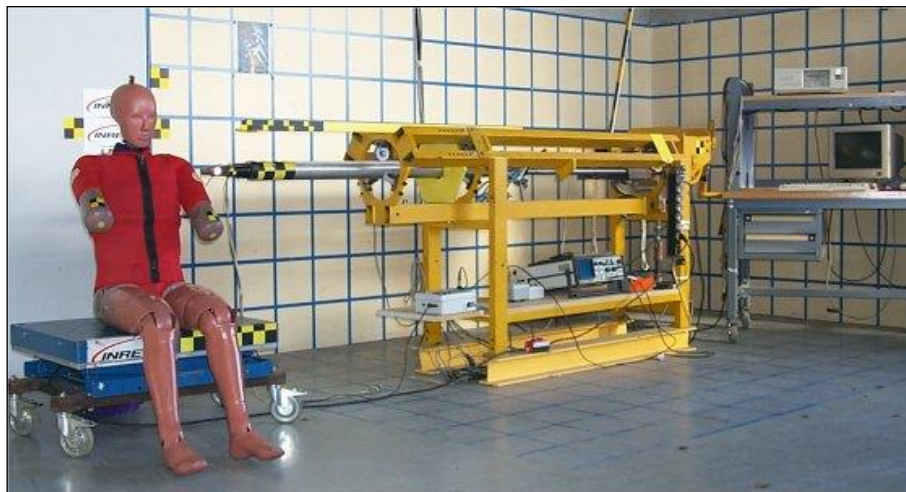
Figure 1 : Impacteur horizontal guidé
