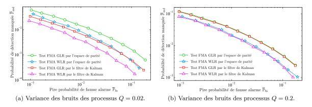
FIGURE B.11 – Comparaison entre le test FMA GLR et le test FMA WLR. La probabilité de détection manquée  $\overline{\mathbb{P}}_{md}$  est exprimée en fonction de la pire probabilité de fausse alarme  $\overline{\mathbb{P}}_{fa}$ . Deux valeurs de la variance des bruits de processus sont considérées : Q = 0.02 et Q = 0.2.
