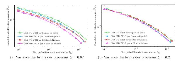
FIGURE B.10 – Comparaison entre le test FMA WLR et le test WL WLR. La probabilité de détection manquée  $\overline{\mathbb{P}}_{md}$  est exprimée en fonction de la pire probabilité de fausse alarme  $\overline{\mathbb{P}}_{fa}$ . Deux valeurs de la variance des bruits de processus sont considérées : Q = 0.02 et Q = 0.2.
