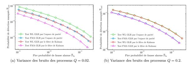
FIGURE B.9 – Comparaison entre le test FMA GLR et le test WL GLR. La probabilité de détection manquée  $\overline{\mathbb{P}}_{md}$  est exprimée comme une fonction de la pire probabilité de fausse alarme  $\overline{\mathbb{P}}_{fa}$ . Deux valeurs de la variance des bruits de processus sont considérées : Q = 0.02 et Q = 0.2.
