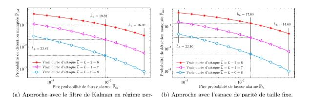
FIGURE B.5 – Sensibilité du test FMA par rapport à la durée d'attaque.
