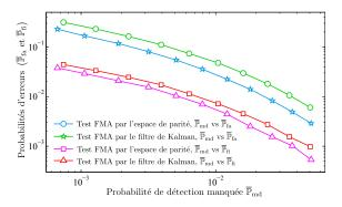
FIGURE B.13 – Comparaison entre l'approche avec le filtre de Kalman et l'approche avec l'espace de parité en utilisant les détecteurs FMA. La pire probabilité de fausse alarme  $\overline{\mathbb{P}}_{fa}$  et la pire probabilité de fausse localisation  $\overline{\mathbb{P}}_{fi}$  sont tracées en fonction de la probabilité de détection manquée  $\overline{\mathbb{P}}_{md}$ .
