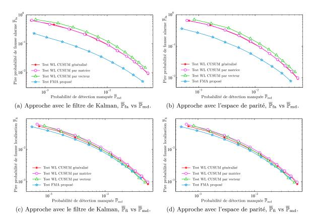
FIGURE B.12 – Comparaison entre le test FMA proposé et les tests classiques (WL CUSUM généralisé, WL CUSUM par matrice et WL CUSUM par vecteur). La pire probabilité de fausse alarme  $\overline{\mathbb{P}}_{fa}$  et la pire probabilité de fausse localisation  $\overline{\mathbb{P}}_{fi}$  sont tracées en fonction de la probabilité de détection manquée  $\overline{\mathbb{P}}_{md}$ .
