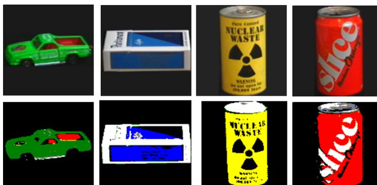
FIGURE 5.3.11: Comparaison des couleurs réelles des objets et celles perçues par le système après apprentissage.
