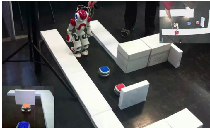
FIGURE 6.3.3: En présence d'obstacles, le robot Nao peut intervenir pour stopper la formation ou demander une nouvelle planification pour contourner cet obstacle.
