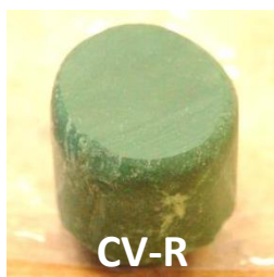
Figure 10 : Céramique après frittage conventionnel de 18 minutes à 800 °C avec une montée de 1000 °C/h
