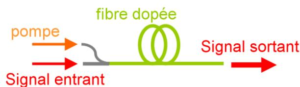
Figure 1.21 : Principe d'un amplificateur à fibre.
