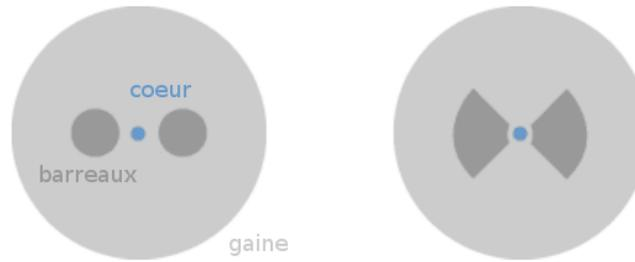
Figure 1.16 : Exemples de fibres à maintien de polarisation. A gauche une fibre de type panda et à droite une fibre nœud papillon.
