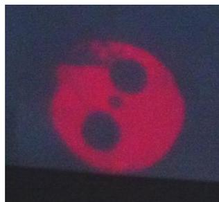
Figure 4.20 : Photographies du laser rouge en sortie de la fibre LMA. Le laser rouge n'est pas couplé dans les barreaux et le cœur.
