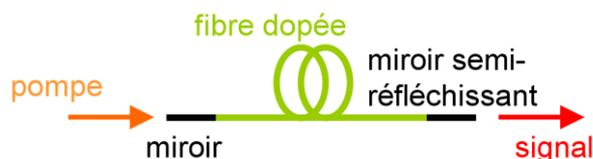
Figure 1.20 : Principe d'un laser à fibre à cavité linéaire.
