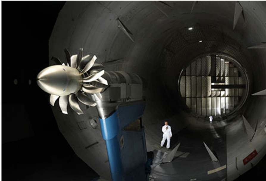
Figure III.1 – Photo du banc d’essai HERA avec un doublet d’hélices SOA-EIS2030 monté dans la soufflerie S1-MA de l’Onera
