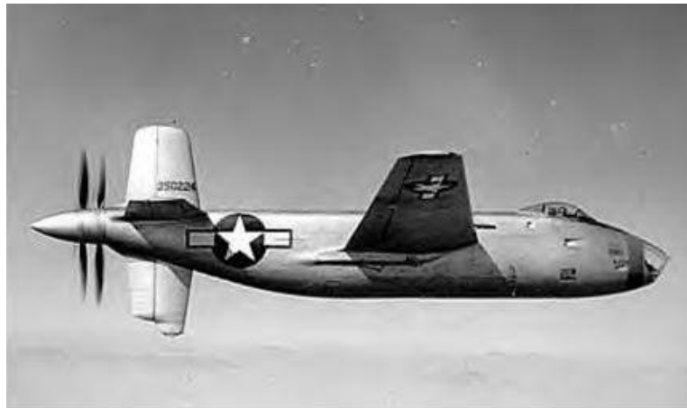
Figure I.1 – Essai en vol du Douglas XB-42, bombardier expérimental avec un doublet d’hélices contrarotatives en queue de fuselage entraîné par deux moteurs Allison V-1710 12 cylindres (vol inaugural le 6 Mai 1944)
